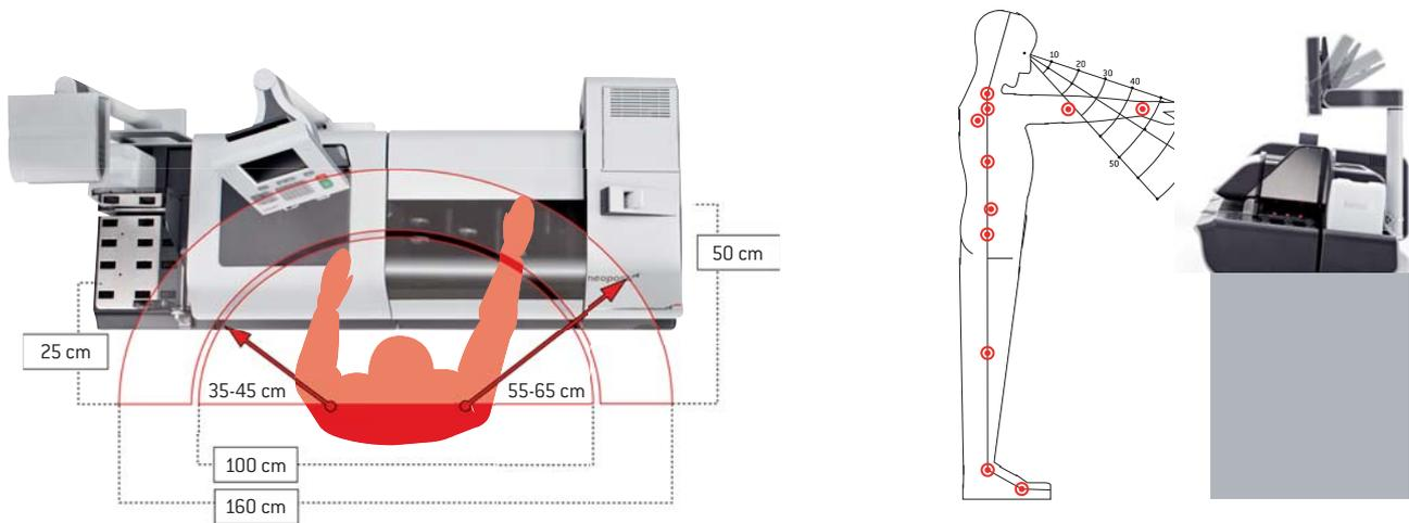
Das technische Design der IS-5000 orientiert sich konsequent am Benutzer. Alle Arbeitsschritte werden von einem zentralen, nach ergonomischen Gesichtspunkten gestalteten Bedienbereich aus gesteuert. Durch den modularen und flexiblen Systemaufbau befinden sich die Komponenten in bequemer Reichweite des Benutzers bzw. können entsprechend platziert werden. Dies erlaubt eine natürliche Körperhaltung und damit einen effizienten, ermüdungsfreien Arbeitsfluss.
