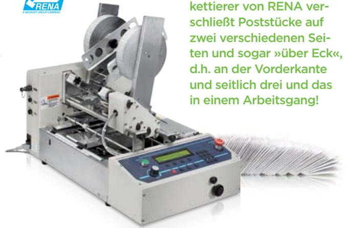
Der variable Tabber/Etikettierer von RENA verschließt Poststücke auf zwei verschiedenen Seiten und sogar »über Eck«, d.h. an der Vorderkante und seitlich drei und das in einem Arbeitsgang!
