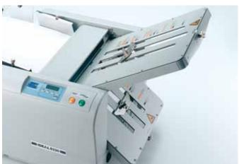
**PAPIERANSCHLÄGE** Die Einstellung der Falzart erfolgt über leicht zu bedienende Papieranschläge an den Falztaschen.
